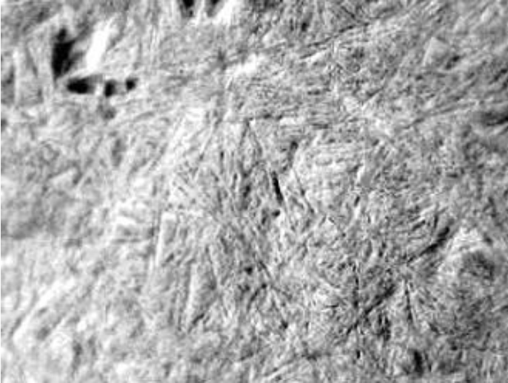
Fig. 7: Fosforslak, blauwe steen van de Kaloot; macrofoto van oppervlak met naaldvormige kristallen. Foto: F.A.D. van Nieulande.
